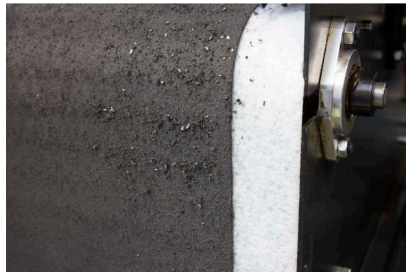
鋳鉄加工時にも切粉を凝集し優れたろ過性を発揮
