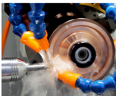
Anca EDG: solution combinée pour l'érosion rotative de PCD et la rectification de carbure
