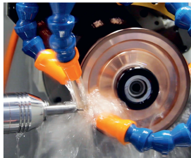
Anca EDG: PKD-Rotationserodieren und Hartmetallwerkzeugschleifen in einem
