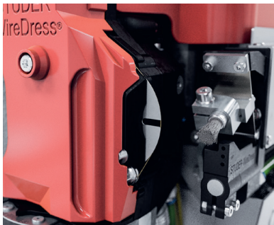
Schleifmaschine, ausgestattet mit WireDress von Studer
